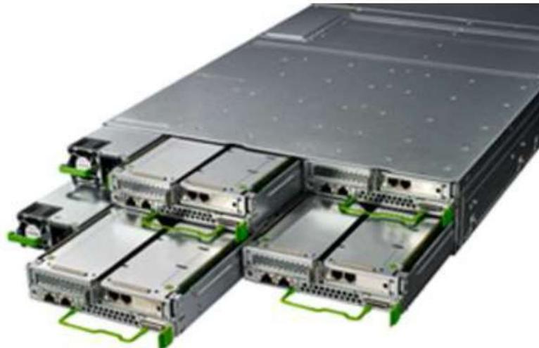
Figura 6: Chassi com 4 Nós mostrando a separação dos NÓS
