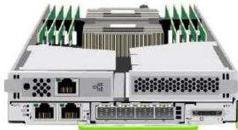
Figura 5: Um NÓ, manutenção independente dos outros 3 NÓS, não é BLADE.
